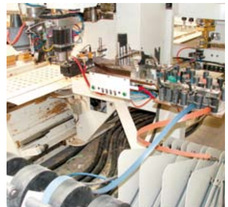
A gép egyszerre 4-féle élzárót kezel, ami lehet élfólia, -furnér, ABS, élléc vagy dekorcsík
