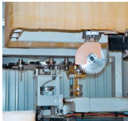
A lapmegmunkáló egységgel marási, fúró- és nótóliási műveletek végezhetőek
