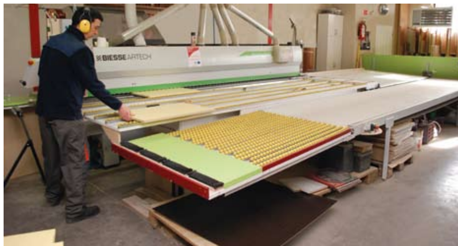
„1 emberes” élzárógép-kiszolgálás az alkatrész-visszavezető egységgel
